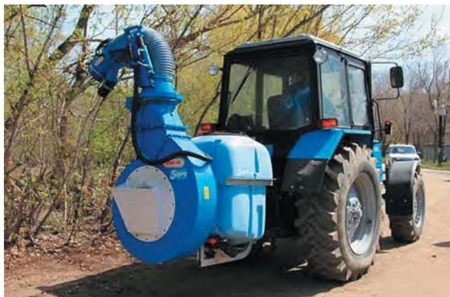
Рис. 7. Пушка для обработки иловых карт
